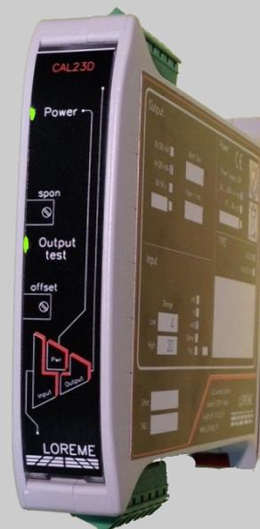
Le conditionneur de mesure CAL23D permet de réaliser l'adaptation et l'isolation d'un large éventail de signaux analogiques dans un process industriel. La triple isolation galvanique (Entrée/Sortie/Alimentation) permet de garantir une sécurité de fonctionnement optimale.
